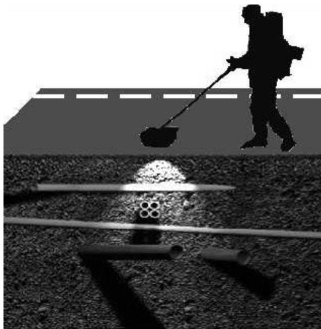
Obr. 1 – Lokalizace inženýrských sítí pomocí georadaru
