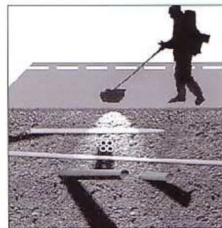
Obr. 1 Lokalizace inženýrských sítí pomocí georadaru
