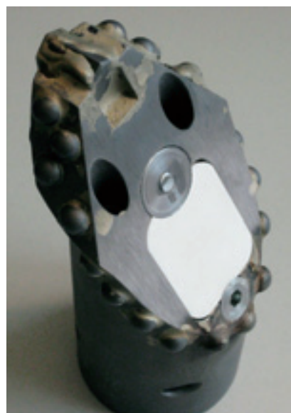
Abb. 4 Keramiksendefenster für eine ORFEUS-Antenne in der Steuerfläche eines Bohrkopfes nach einem Bohrtestlauf
