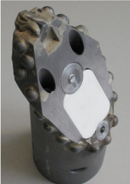
Abb. 4: Keramisches Sendefenster für eine Orfeus-Antenne in der Steuerfläche eines Bohrkopfes nach einem Bohrtestlauf
